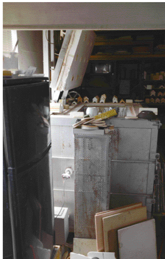
電気窯には色見穴も付けられている
